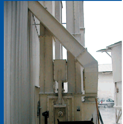
Sistema di tensionamento a contrappeso Gravity take-up system
