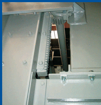
Testata di rinvio con contrappeso Tail head with gravity take-up
