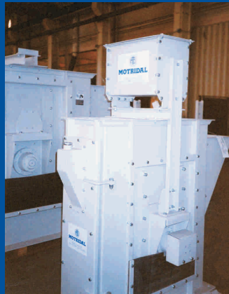
Testata di rinvio con contrappeso Tail head with gravity take-up
