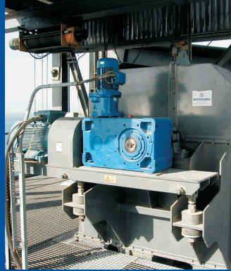
Motoriduttore accoppiato direttamente all'albero Motorgear directly mounted on the drive shaft
