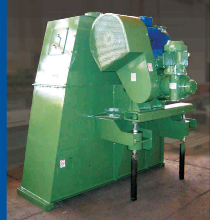
Motorizzazione con trasmissione a cinghia Drive unit with belt drive
